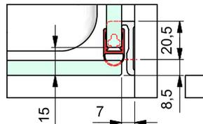
d) mit Dichtprofil 8861KU0-8 und Türanschlag z.B. 8274
