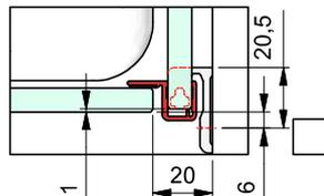
c) mit Dichtprofil 8861KU0-8 und Türanschlag-Trägerprofil 8880
