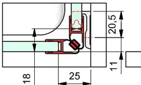
b) mit Dichtprofil 8855KU0-8 und Türanschlag-Trägerprofil 8880
