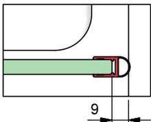
b) mit Dichtprofil 8851KU0-8 und Türanschlag-Trägerprofil 8880
