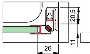
c) mit Dichtprofil 8855KU0-8 und Türanschlag-Trägerprofil 8880
