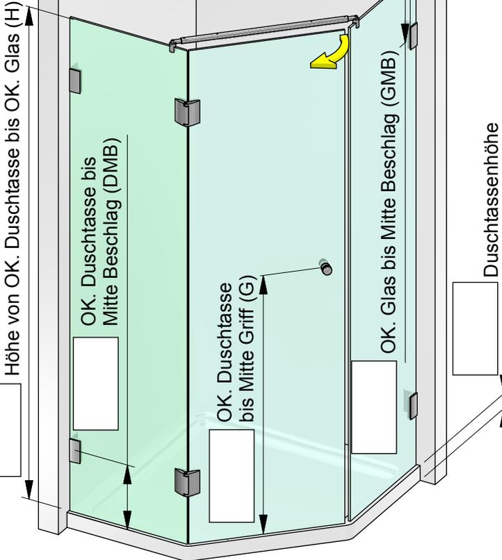
Die hier dargestellte Verwendung von Stabilisationsstangen ist als Beispiel anzusehen. Größe und Position der Stabilisationsstangen ist abhängig von der Glasgröße!
